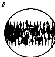
На рис.: Генератор «белого шума»: а - принципиальная электрическая схема; б - осциллограмма белого шума.
